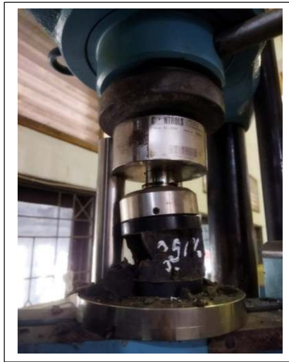
Gambar 3. Paving block hancur setelah di uji tekan
