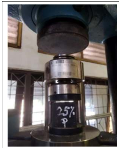
Gambar 2. Uji Kuat Tekan Paving block pada umur 14 hari
