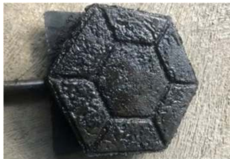
Gambar 2. Paving block sampah plastik hasil program pengabdian di Desa Banglarangan Sumber: penulis (2024)
